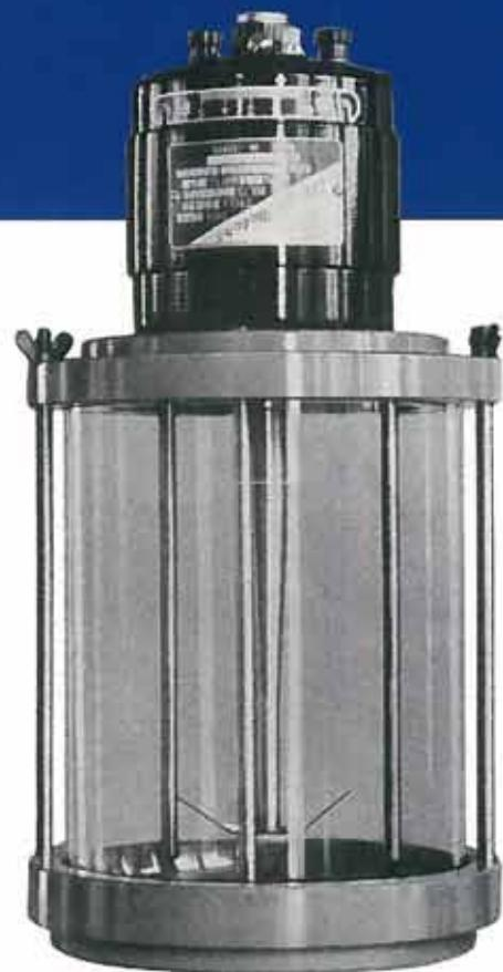
本器はNIK法に基き一般鋳物砂の粘土分並びに砂粒分の百分率を検出するに用うる器械にして1/20馬力単相電動機(600~3000R.P.M無段変速)、羽根軸、ビーカー、サイフォン、タイマーにより成り立つものである。
