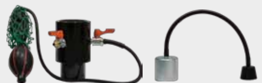
ポンプ 乾燥砂試験筒 鋳型用治具
