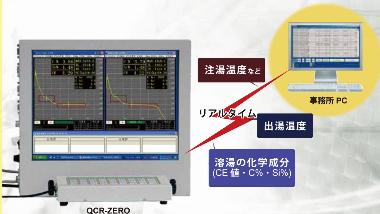
溶解現場における溶湯の品質管理データ (溶湯の材質、CE 値、C%、Si%、注湯温度、及びその溶湯が注湯された品名、品番等)をリアルタイムに把握します。
