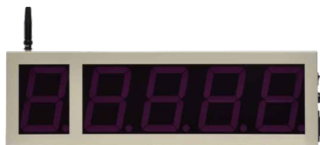
温度計ID(1桁) 温度(4桁)
