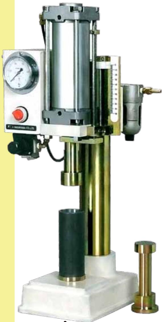
本器は、鋳物砂のコンパクトビリティを測定する試験器で、エア式圧縮試験器と試料投入器から成っています。コンパクトビリティは鋳物砂を手で握って判断する官能的な試験を定量化したものです。
